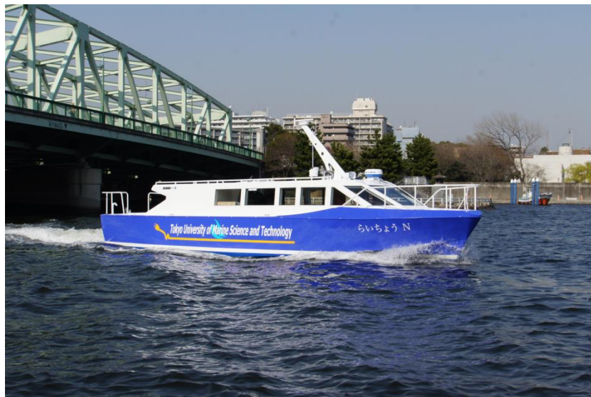
東京海洋大学建造 電池推進船 『らいちょう N』
